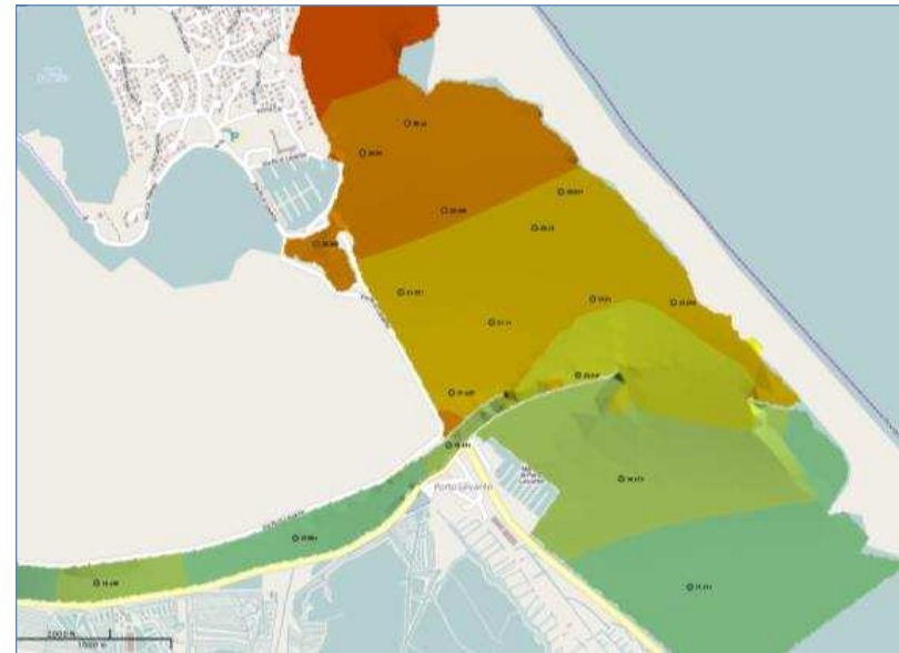
Figure 7-20: Salinit  per livello profondo della marea crescente
