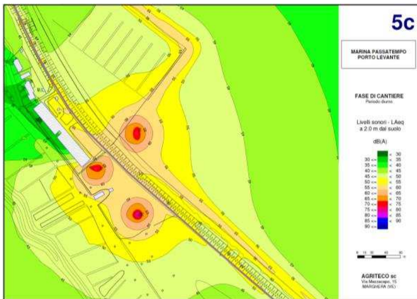
Figura 8-32 – Elaborazione modellistica previsionale del rumore – Fase di cantiere (tre macchine)
