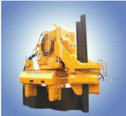
Figura 8-29: macchinario sostitutivo della classica pala meccanica, denominato Still Worker, modello ZU-100.
