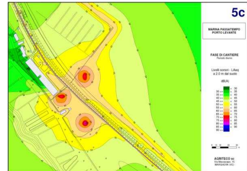
Figura 8-11: Livelli sonori con una macchina a elevata emissione sonora in funzione.
