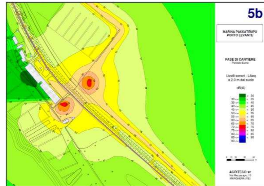
Figura 8-31 – Elaborazione modellistica previsionale del rumore – Fase di cantiere (due macchine)
