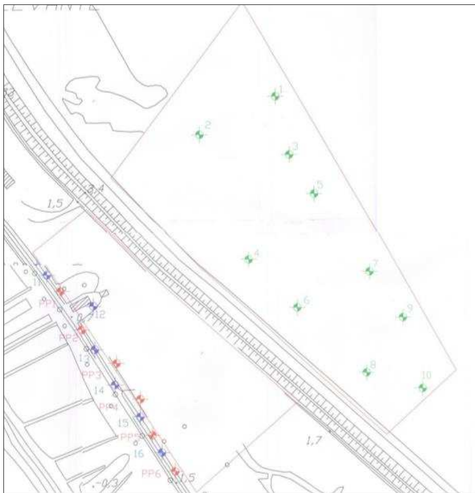
Figura 3-11: Localizzazione dei punti di sondaggio geognostico.
