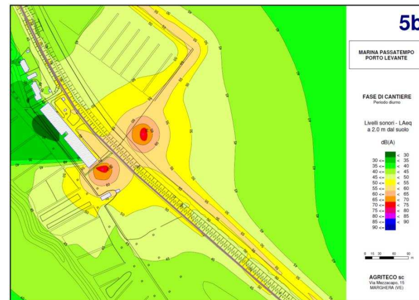
Figura 3-61 – Elaborazione modellistica previsionale del rumore – Fase di cantiere (due macchine)
