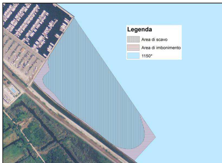
Figura 4-21 Superficie di imbonimento e superficie di scavo interessanti l'habitat 1150* Lagune costiere
