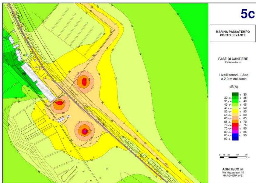
Figura 3-62 – Elaborazione modellistica previsionale del rumore – Fase di cantiere (tre macchine)
