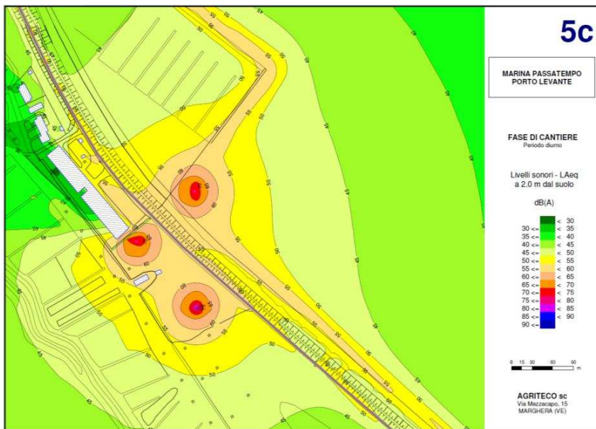
Figura 4-25 – Elaborazione modellistica previsionale del rumore – Fase di cantiere (tre macchine)
