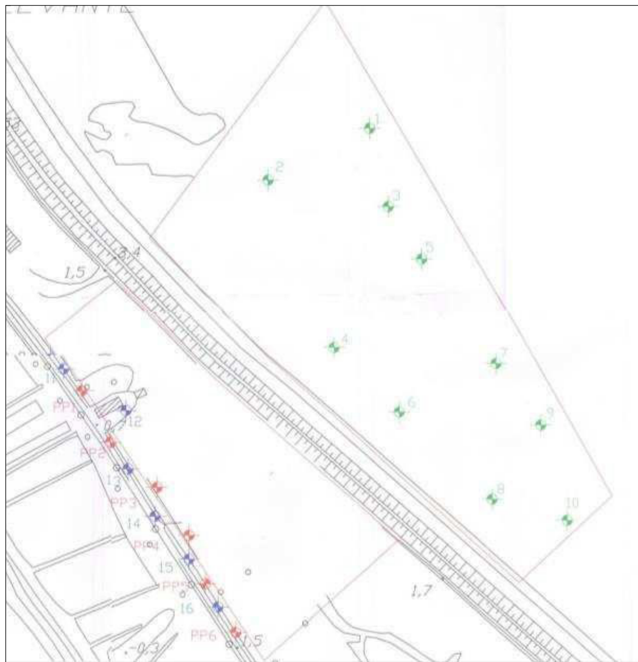
Figura 3-11: Localizzazione dei punti di sondaggio geognostico.
